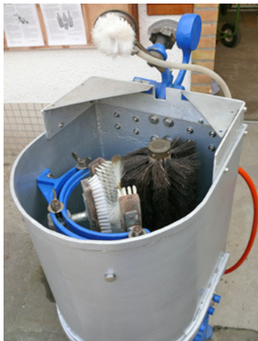
Einsicht von oben in das Bürstwerk mit hinterem Spritzschutzrand.
