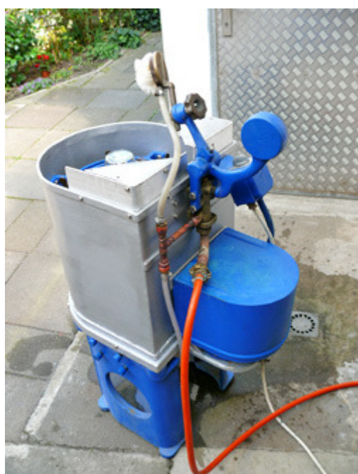
Ansicht von hinten mit der Wasserverteilung und im unteren Teil 4 Fettbuchsen für die Lagerfettung der Antriebswellen beider Bürsten.
